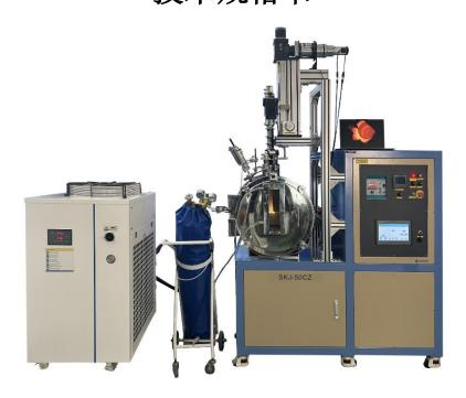
SKJ-50CZ 是顶部籽晶法晶体生长炉,可利用助溶剂法生长各种材料单晶。配备精密旋转提拉机构可用于顶部提拉籽晶助溶剂法生长各种晶体材料,提拉和旋转速度采用 PLC 触摸屏控制,操作简单。采用感应加热,最高温度可到达 1200℃,24 段可编程控制器,可根据不同的客户需求来设定升降温程序。配备精密旋转提拉机构可用于生长各种晶体材料,提拉速度和旋转速度均可根据客户要求定制。
