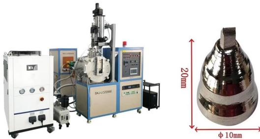
合肥科晶设计和生产了一款特殊的提拉法单晶生长设备，采用真空悬浮熔炼，其温度可达 2000℃。此系统包含一个高频感应电源，高真空腔体，水冷铜坩埚（用于悬浮熔炼）和精密提拉机构。悬浮熔炼避免了样品被坩埚污染，可以得到高纯度的金属单晶。
