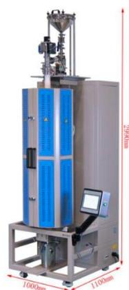
OTF-1700X-III-VT-AF 是一款立式 3 温区粉体球化炉，最高温度可达 1700℃。设备主要组成：一个速度可调的振动送料器，一个 3 温区立式炉和一个水冷收集罐。整的系统可让材料在惰性气体保护环境下加热球化处理，可对各种材质的粉末加热球化。
