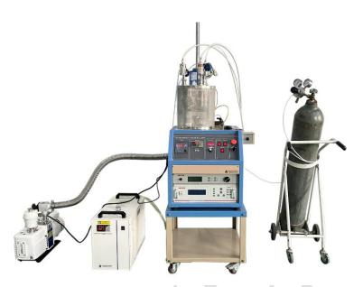
VTC-3RF 是一款三靶磁控溅射镀膜仪,配有磁控等离子溅射头和射频等离子电源,此款设备主要用于制作非导电薄膜,对于新型非导电薄膜的探索,它是一款性价比高并且高效的实验帮手。
